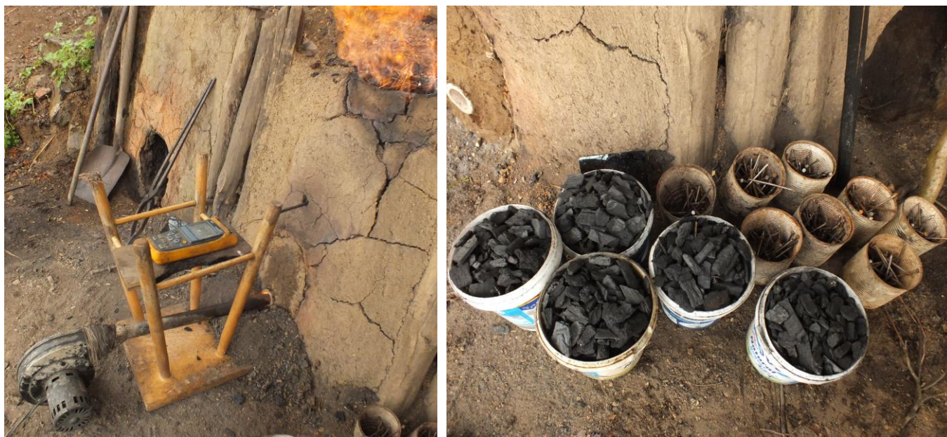
3. ábra: A kiskohó üzem közben a centrifugál ventilátorral és felette a hőelemmel (balra), a kimért betétanyagok 400g faszén joghurtos vödrökben és 200g szeg konzervesdobozokban.
