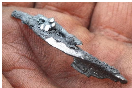
11. ábra: A mK1-2,8-as kísérletnél a fúvókán át bedugott vaspálcára véletlenül csöppent (kis széntartalmúvá frissült) nyersvas
