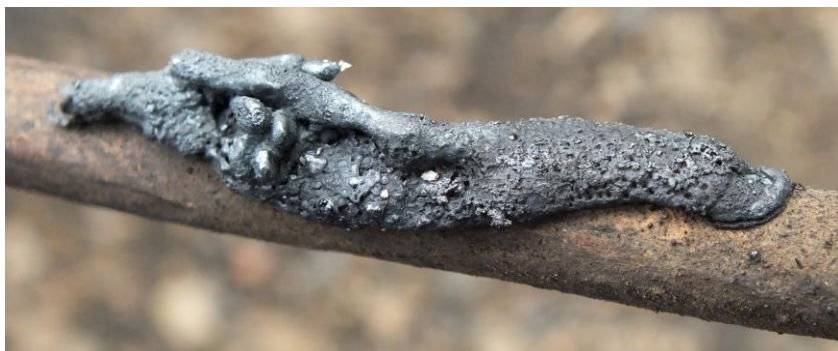
11. ábra: A mK1-2,8-as kísérletnél a fúvókán át bedugott vaspálcára véletlenül csöppent (kis széntartalmúvá frissült) nyersvas
