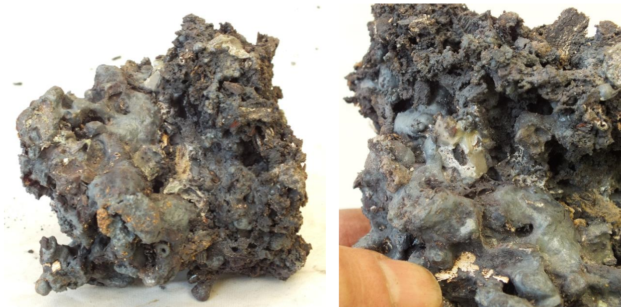
5. Ábra: A hK3-1,5 kísérlet vasbucája az oldalára fektetve: felül vasszivacs, alul nyersvas (balra). A vasszivacs és a nyersvas határa a vasbucában, a nyersvas szörke salakkal vegyülve (jobbra).
